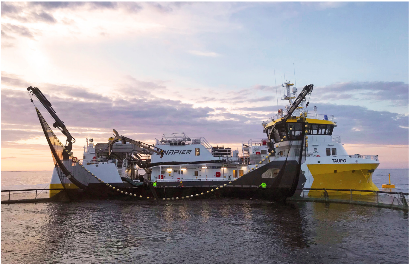
Med bløggebåt avlives fisken direkte etter trenging og pumping opp fra merd, og dermed unngås ytterligere stress i forbindelse med transport og pumping til slakteri og eventuell ventemerd. Foto: Espen Samdal
